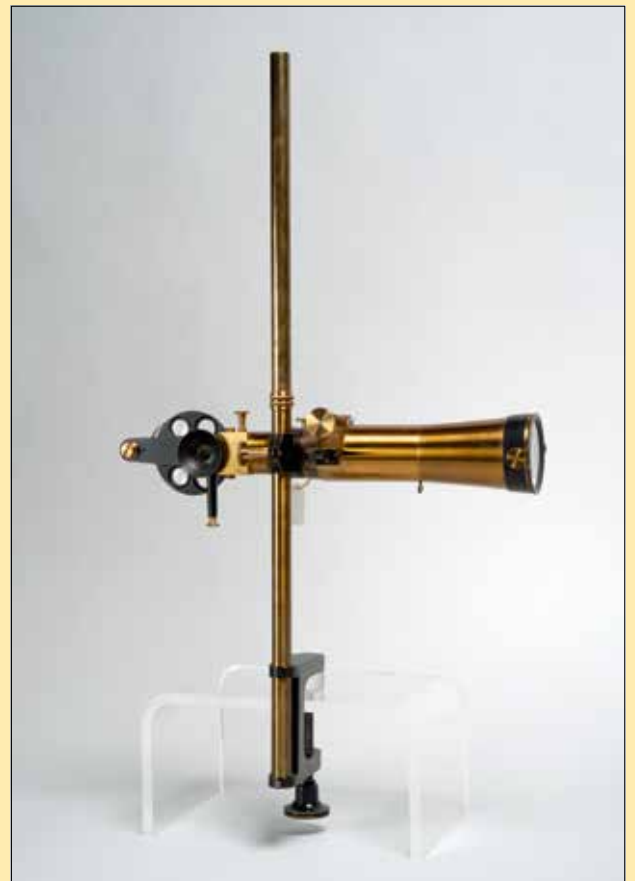
Statief-oogspiegel (verbeterde versie december 1853) ontworpen door Donders en vervaardigd door G.J.A. Epkens.
